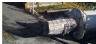
Identische Explosion mit dem Q-Rohr®: keine Hitzeentwicklung außerhalb, geringer Druckaufbau bei minimaler Lautstärke.
